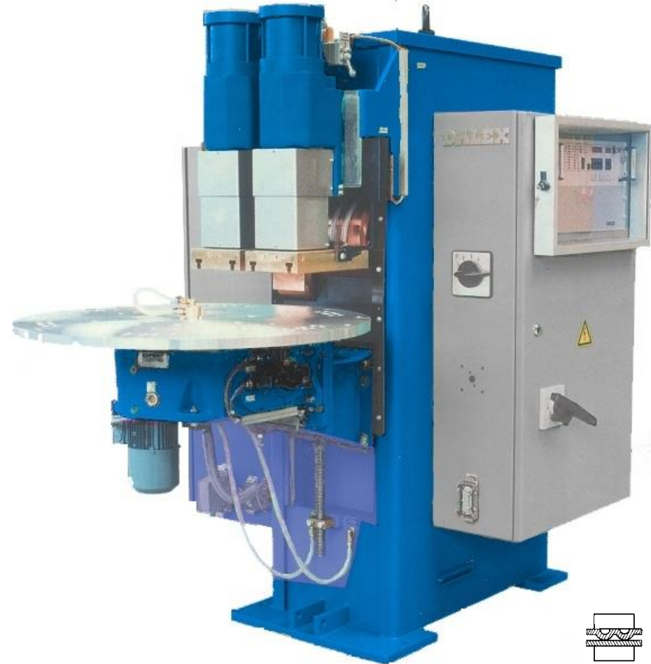
DALEX-Doppelkopf-Buckelschweißmaschine in Drehtischausführung für Serienschweißung (Abb.1)
